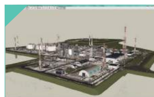
Работа с облаком точек лазерного сканирования
